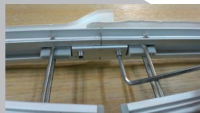
取り付け部材のネジは、同じく同梱されていた六角で締めます。
